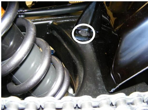
8. Sichern Sie die Bremsleitungen mittels des Clips.
