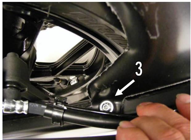
7. Verwenden Sie den originalen Kunststoffniet um die Hinterradabdeckung auf der Schwinge vorne zu befestigen.
