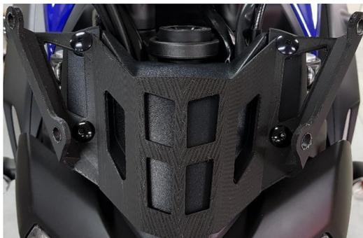
3. Montieren Sie nun die Scheibe mittels den Schrauben M5 x 25mm und U-Scheiben am Halter
