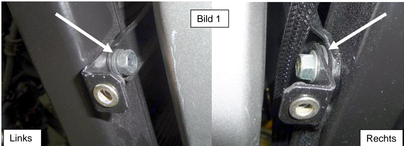
Achtung! Auf der rechten Seite muss der Halter auf die originale U-Scheibe montiert werden. Auf der linken Seite muss der Halter zwischen den Kühler und die originale Aufnahme montiert werden!
