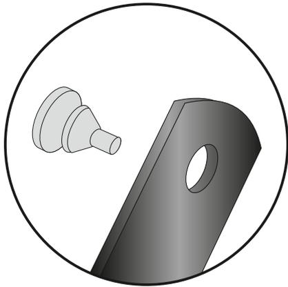
Anschlaggummis in die Bohrungen am Hauptständer einziehen.
