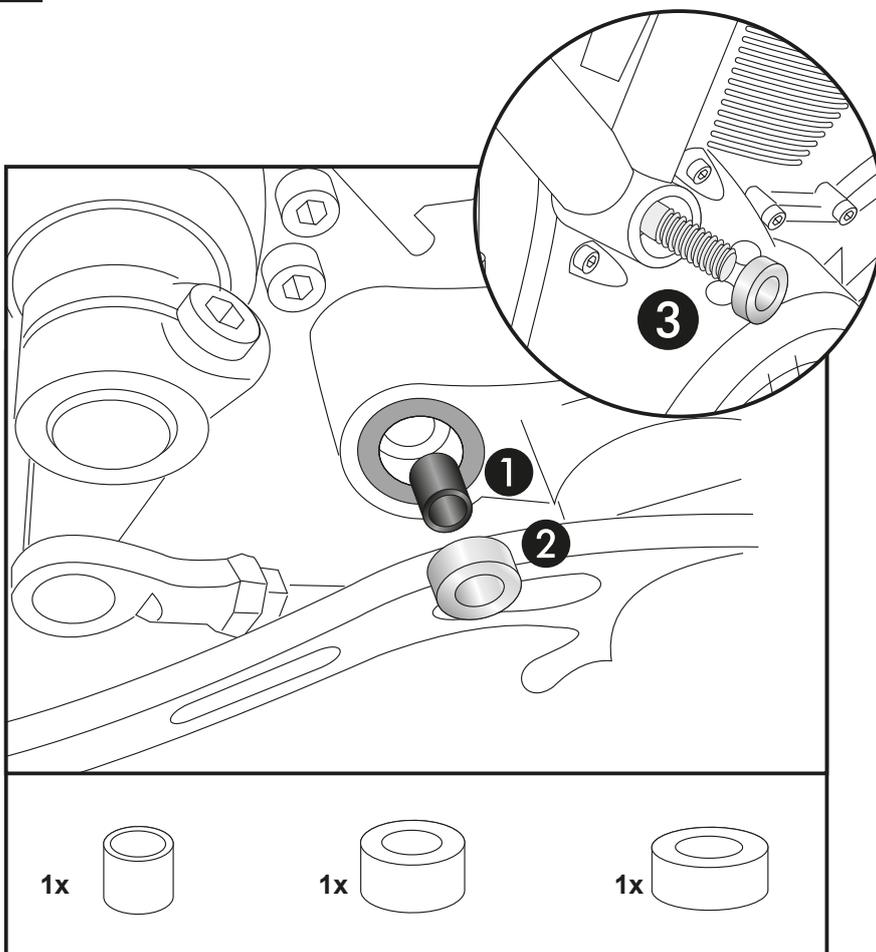
Zuerst das Verbindungsstück in das offene Ende des bereits montierten Motorschutzbügels stecken.
