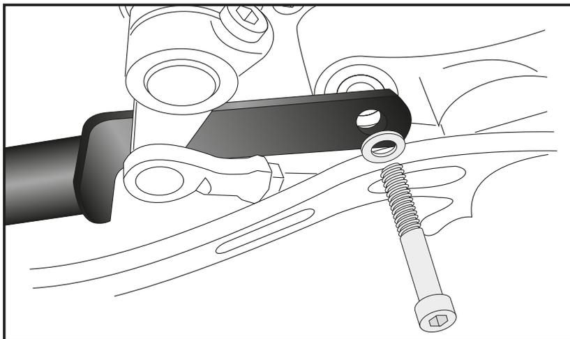
Montage des Motorschutzbügels links oben:
