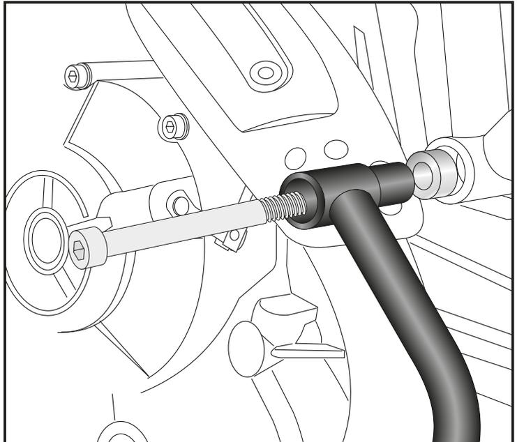
**2** Montage des Motorschutzbügels rechts unten:
