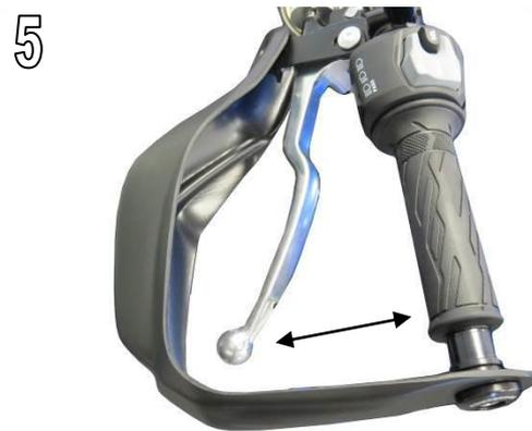
**WICHTIG: Überprüfen Sie regelmäßig die Ausrichtung der Handschützer und die Spannung der Befestigungsschrauben. / IMPORTANT: Always check alignment of hand guards and mounting bolt tension periodically.**
