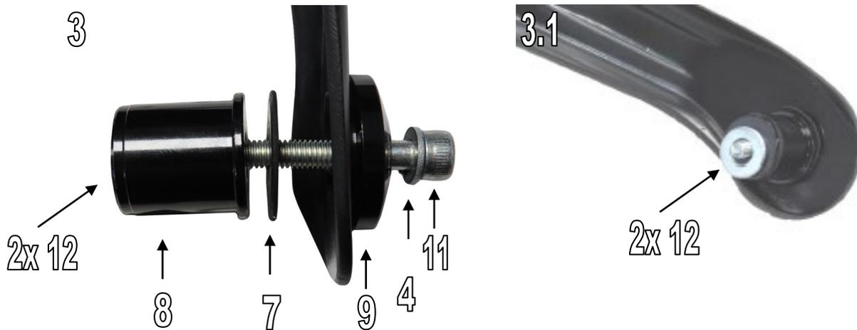
6. Montieren Sie die Handprotektoren mit den Lenkerendeneinsätzen und ziehen Sie die Schrauben(11) fest. Befestigen Sie die Handprotektoren mit den M6 x 20 Schrauben (5) und M6 Muttern (3) an den Halterungen Abb.4 / Fit hand guards using bar end inserts and tighten cap socket screws (11). Fit the hand guards to the brackets using the M6 x 20 screws (5) and M6 Flange nuts (3) Fig.4
